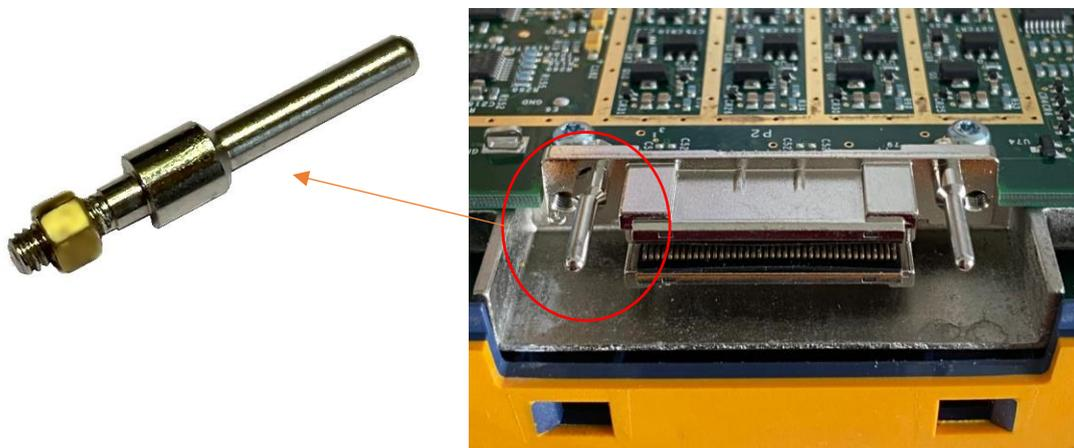
Направляющие предназначены для безопасного подключения различных модулей для кабельных анализаторов Fluke DTX-1200, Fluke DTX-1800 и др. совместимых приборов серии DTX, Fluke DSX-600, Fluke DSX-5000, Fluke DSX-8000 и др. совместимых приборов серии DSX.
