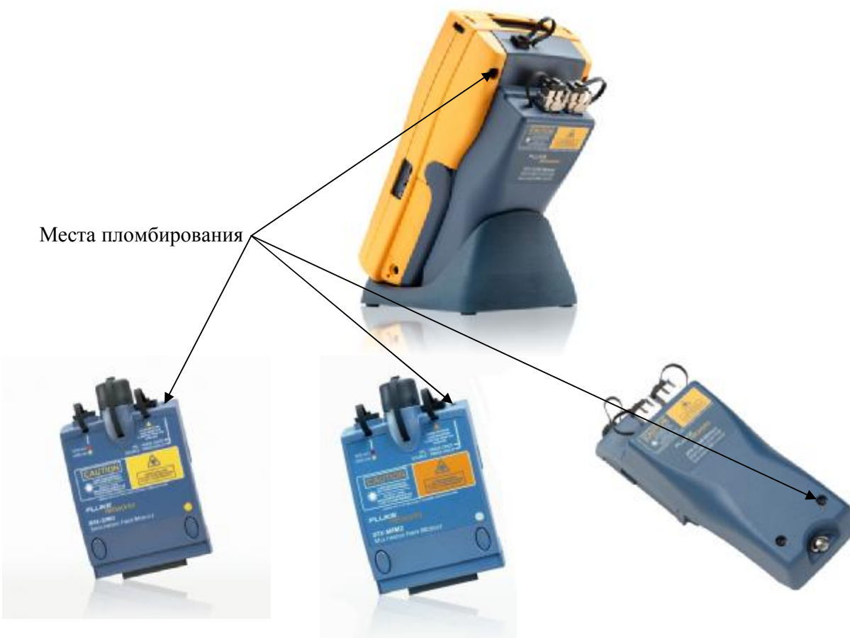
Рисунок 3 - Места пломбирования от несанкционированного доступа
