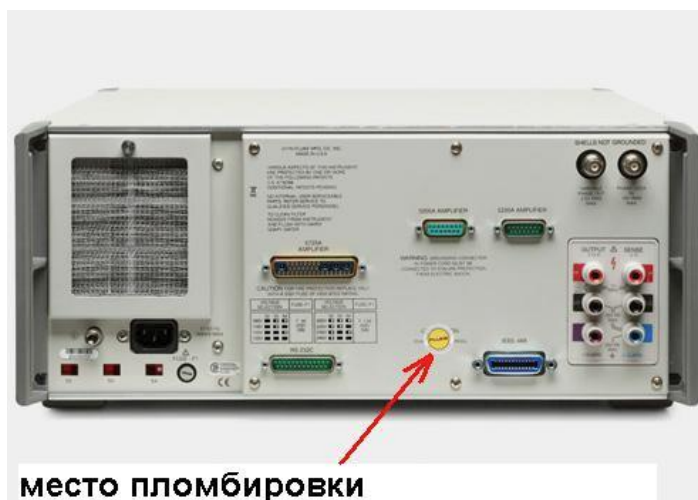
Рисунок 3 – Схема пломбировки от несанкционированного доступа.
