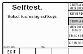
Выбор 'DISPLAY' преобразует экран к экрану 'Display test – Тест дисплея'. Он приглашает пользователя использовать кнопку табуляции лицевой панели 'tab' (⇧) для перемещения черной полосы вниз экрана, затем вверх экрана и снова вниз, тестируя таким образом все элементы дисплея на экране:
