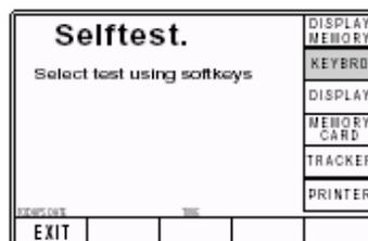
Выбор 'KEYBRD' преобразует экран к экрану 'Keyboard test – Тест клавиатуры'. Он предлагает пользователю нажать тестируемую кнопку на передней панели и выводит на экран результат тестирования последней нажатой кнопки:
